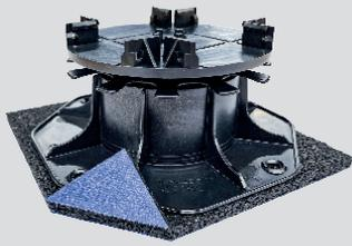
Das Isopad mit Beschichtung dient zum Schutz vor mechanischen Beschädigungen auf hochwertigen Dachabdichtungen. Es besitzt eine unterseitige Kaschierung mit blauer Geotextilie, die als integrierte Trennlage (Weichmacherbarriere) bei Unverträglichkeit zu PVC-Dachabdichtungsbahnen fungieren kann. Bei einer punktuellen Unterlegung der Unterkonstruktion entsteht kein direkter Kontakt zum Untergrund und das Wasser kann barrierefrei ablaufen. Zusätzlich wird der Trittschall gedämpft.
